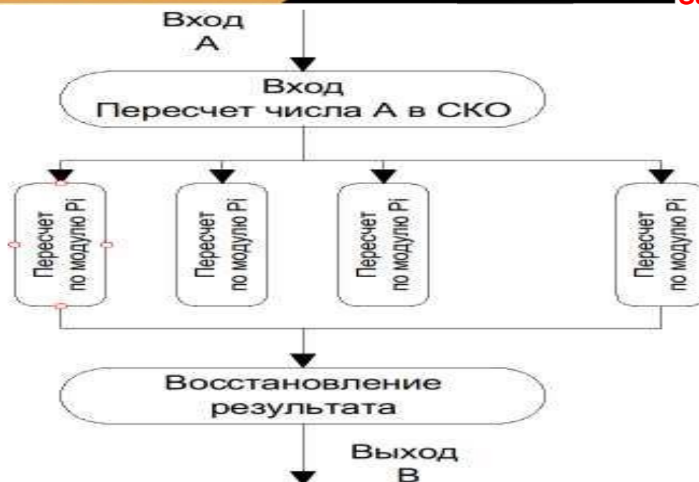
Рис.1. Схема программной модели процессора в СКВ
